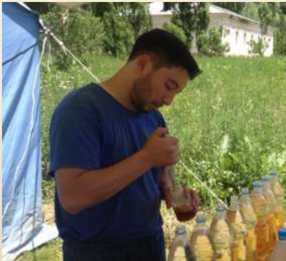
Осаждение урана на гидроксиде железа в полевых условиях
