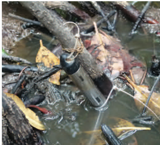
Gambar 15. Water level logger yang terpasang di akar mangrove .
