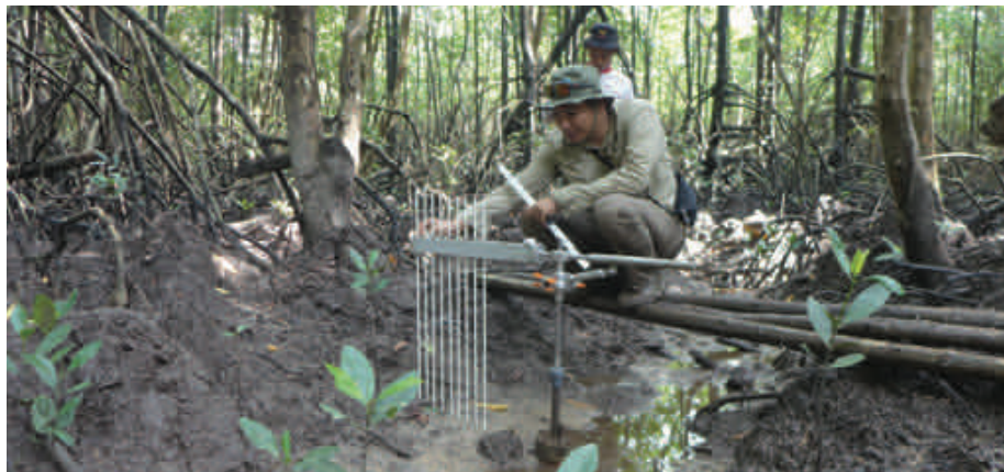
Gambar 19. Pengukuran elevasi permukaan tanah dengan Rod surface elevation table (RSET) di stasiun monitoring. Alat ukur ( arm ) ditempatkan pada benchmark RSET hanya pada setiap saat pengukuran.
